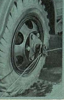
Рис. 6. Лебедка-самовытаскиватель и приспособление для направления троса на барабан лебедки.
